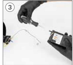
Una los cables del motor principal con los orificios del driver, cada uno correspondiendo con su color. Con ayuda de un destornillador, apriete los tornillos para que los cables queden correctamente sujetos.
