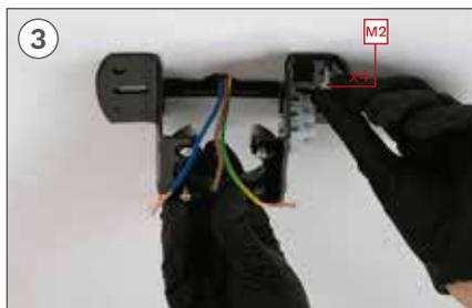
3 Coloque la arandela y posteriormente el tornillo M2.
