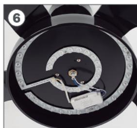
A continuación, coloque enl driver en la pieza G por la parte de los imanes sin que tape ningún led.
