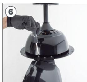
Inserte el aspa E en una de las ranuras de la pieza H hasta que esté colocada correctamente. Una vez haya colocado el aspa E, atorníllela con 3 de los tornillos del paso 1.
