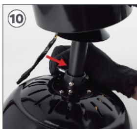
Una vez introducida la barra, coloque el pasador de la pieza I de manera que coincida con el agujero de la barra.
