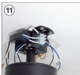
A continuación, con la ayuda de un destornillador plano, conecte los cables restantes de la pieza B a los del ventilador, uniendo cada uno con la regleta y su respectivo color.
