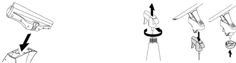
Schließen Sie die Rakeldüse an den Abscheider an, bis sie hörbar einrastet.
