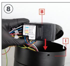
Una vez conectados los cables, introduzca la pieza **B** dentro de la pieza **I**.
