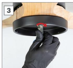
Introduzca con cuidado los cables del ventilador por el interior de la pieza Q y sáquelos por el agujero grande lateral de la pieza. Después, enrosque la pieza Q y compruebe que queda bien sujeta al ventilador.
