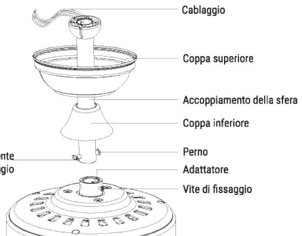
**Suggerimento:** per facilitare l'introduzione dei cavi nell'asta, applicare del nastro isolante intorno ai cavi. Ciò li manderà uniti mentre vengono inseriti nell'asta.
