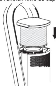
4. Après l'assemblage, remettez-le sur l'unité principale et tournez-le dans le sens des aiguilles d'une montre pour le fixer.
