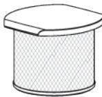
3. Il nuovo filtro e il coperchio superiore sono fissati e assemblati con una fibbia.
