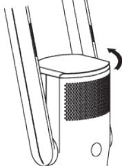
1. Draai de bovenklep van het filtersysteem linksom om het filter te ontgrendelen en te verwijderen.
