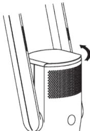
1. Drehen Sie die obere Abdeckung des Filtersystems gegen den Uhrzeigersinn, um den Filter zu entriegeln und zu entfernen.
