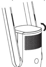
1. Gire a tampa superior do sistema de filtro no sentido anti-horário para destravar e remover o filtro.
