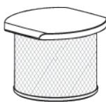
3. Le nouveau filtre et le couvercle supérieur sont fixés et assemblés avec une boucle.
