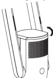
1. Gire la cubierta superior del sistema de filtro hacia la izquierda para desbloquear y quitar el filtro.
