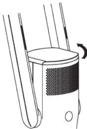
1. Ruotare il coperchio superiore del sistema di filtri in senso antiorario per sbloccare e rimuovere il filtro.
