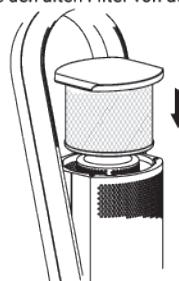
4. Setzen Sie es nach dem Zusammenbau wieder auf das Hauptgerät und drehen Sie es im Uhrzeigersinn, um es zu sichern.
