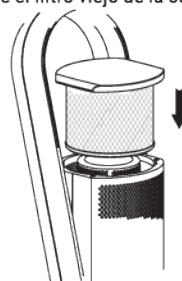
4. Despues del montaje, vuelva a colocarlo en la unidad principal y gírelo hacia la derecha para asegurarlo.
