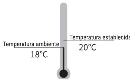
**Nota:** La temperatura predeterminada es 20 °C. En el modo calor, cuando la temperatura ambiente es inferior a 0 °C, la pantalla solo muestra 01, no muestra valores de temperatura negativos. A las 9 horas de uso continuo del modo calor, la máquina dejará de funcionar automáticamente. Reinicie pulsando el botón de encendido de la unidad o usando el mando a distancia.
