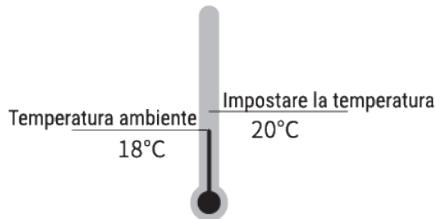
**Nota:** La temperatura predefinita è 20 °C. In modalità riscaldamento, quando la temperatura ambiente è inferiore a 0 °C, il display mostra solo 01, non mostra valori di temperatura negativi. Dopo 9 ore di uso continuo della modalità di riscaldamento, la macchina smetterà di funzionare automaticamente. Riavviare premendo il pulsante di accensione sull'unità o utilizzando il telecomando.
