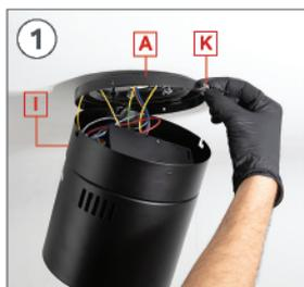
Utilisez 2 vis **K** et vissez-les sans serrer dans les trous parallèles de la pièce **A**.
