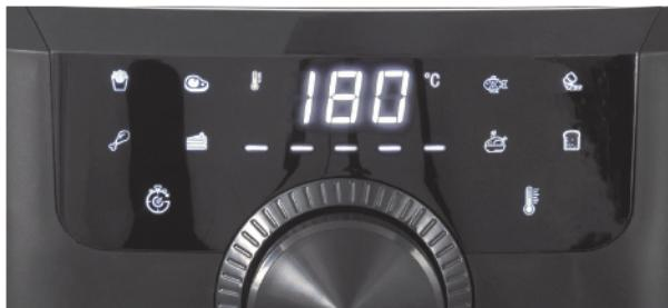
**Nota:** Verm com 8 funções: Batatas fritas, assadas, peixe, camarões, coxa de frango, biscoito, frango e pão. Pressione o menu desejado para selecionar a função de cozedura adequada. Se necessitar de definições e temperaturas mais flexíveis, pode ajustá-las directamente premindo o botão correspondente. O seletor de potência pode ajustar o tempo; aumentar/diminuir um minuto por volta e ajustar a definição de temperatura: aumentar/diminuir 5 graus por volta.
