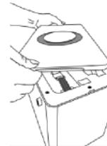
• **Schritt 2:** Bewegen Sie die gelöste Platte vorsichtig zur Seite des Reinigungskörpers, trennen Sie dann die FFC-Kabelschnallenplatte vorsichtig mit Ihren Fingern vom Hauptkörper und halten Sie die Platte offen. (siehe Abbildung 3)
