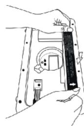
• **Schritt 4:** Richten Sie das soeben entfernte Panel mit dem FFC-Kabel aus und drücken Sie die Taste (Abbildung 7). Siehe jedoch zuerst Abbildung 6.
