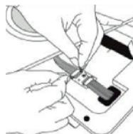
• **Étape 3:** Tirez l'écran du filtre HEPA directement en tirant vers le haut avec les deux mains (Figure 4), pour le remplacer, notez le sens de la flèche étiquetée sur l'écran du filtre (Figure 5).
