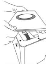
• **Passo 2:** Spostare delicatamente il pannello allentato sul lato del corpo del purificatore, quindi separare delicatamente il pannello della fibbia del cavo FFC dal corpo principale con le dita, quindi tenere aperto il pannello. (vedi figura 3)
