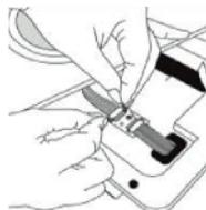
• **Schritt 3:** Ziehen Sie das HEPA-Filtersieb direkt mit beiden Händen nach oben (Abbildung 4). Beachten Sie zum Ersetzen die Pfeilrichtung auf dem Filtersieb (Abbildung 5).
