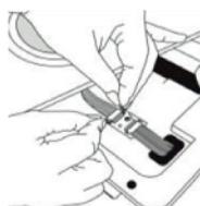
• **Krok 3:** Wyciągnij ekran filtra HEPA bezpośrednio, podnosząc go obiema rękami (rysunek 4), aby go wymienić, zwróć uwagę na kierunek strzałki oznaczonej na ekranie filtru (rysunek 5).
