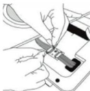
• **Passo 3:** Puxe a tela do filtro HEPA diretamente, puxando para cima com as duas mãos (Figura 4), para substituí-la, observe a direção da seta rotulada na tela do filtro (Figura 5).
