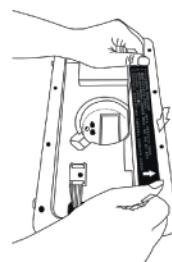
• **Stap 4:** Lijn het paneel dat u zojuist hebt verwijderd uit met de FFC-kabel en druk op de knop (Figuur 7), maar zie eerst Figuur 6.
