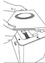
• **Stap 2:** Beweeg het losgemaakte paneel voorzichtig naar de zijkant van het zuiveringslichaam, scheid vervolgens voorzichtig het FFC-kabelgespannel van het hoofdgedeelte met uw vingers en houd het paneel open. (zie figuur 3)
