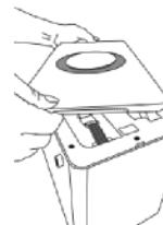
• **Étape 2:** Déplacez doucement le panneau desserré sur le côté du corps du purificateur, puis séparez doucement le panneau de boucle de câble FFC du corps principal avec vos doigts, puis maintenez le panneau ouvert. (voir figure 3)
