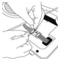
• **Stap 3:** Trek het HEPA-filterscherm direct uit door het met beide handen omhoog te trekken (Figuur 4). Om het te vervangen, let op de richting van de pijl op het filterscherm (Figuur 5).
