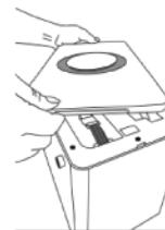
• **Passo 2:** Mova delicadamente o painel solto para a lateral do corpo do purificador, depois separe cuidadosamente o painel da fivela do cabo FFC do corpo principal com os dedos e mantenha o painel aberto. (veja a figura 3)
