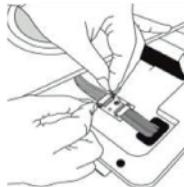
• **Paso 3:** Saque la pantalla del filtro HEPA directamente tirando hacia arriba con ambas manos (Figura 4), para volver a colocarlo, tenga en cuenta la dirección de la flecha en etiqueta en la pantalla del filtro (Figura 5).
