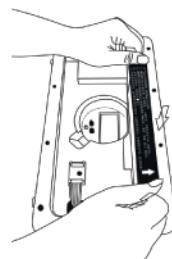
• **Passo 4:** Aline o painel que você acabou de remover com o cabo FFC e pressione o botão (Figura 7), mas primeiro veja a Figura 6.
